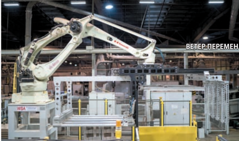
Готовую продукцию отправляет на склад «рука» робота
