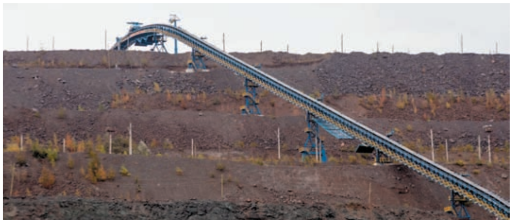
Уникальный крутонаклонный дробильно-конвейерный комплекс в карьере
