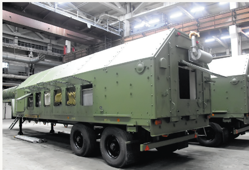
Электростанция мощностью 2х100 кВт
