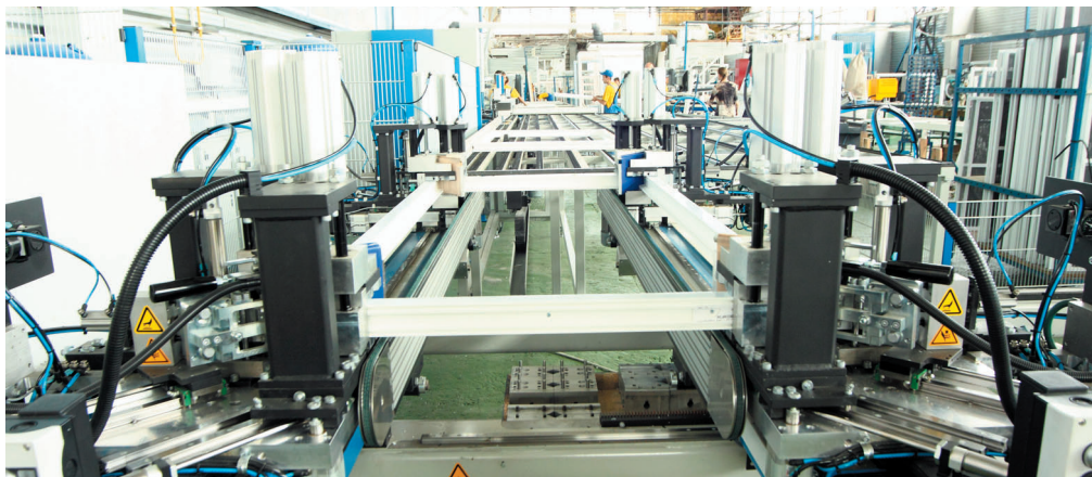
Производительность немецкой автоматической конвейерной линии STURTZ более 200 окон за смену
