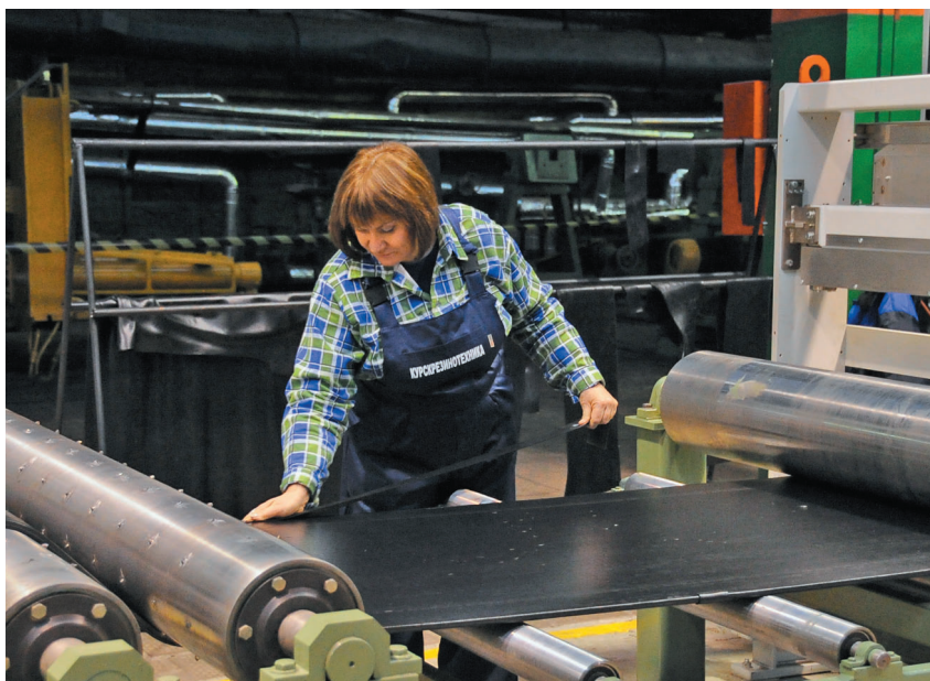
Введенная в строй новая каландровая линия позволяет резко увеличить производительность труда и качество выпускаемой продукции
