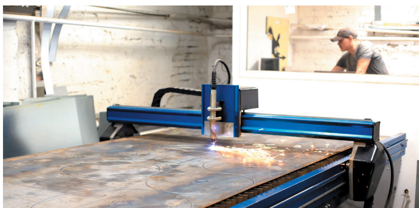
Инновационные технологии поставлены на службу специалистам. Установка плазменной резки
