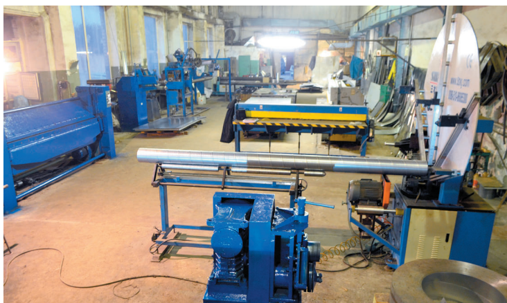
Мастерская Монтаж-Сервиса. Здесь изготавливают воздуховоды различного диаметра
