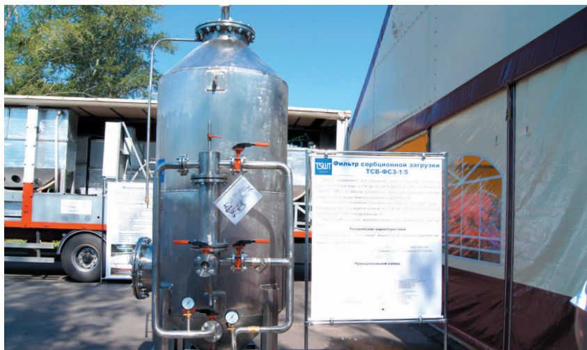
Фильтр сорбционной загрузки предназначен для улучшения органолептических показателей качества питьевой воды
