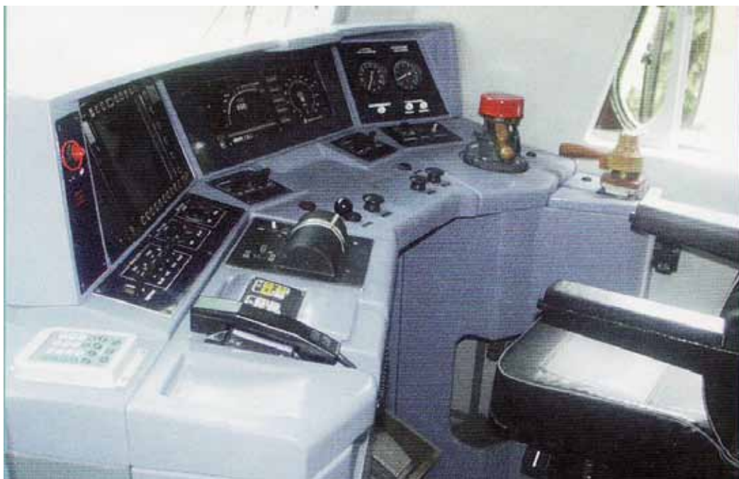
Рис.118. Пульт управления в кабине машиниста тепловоза 2ТЭ70.
