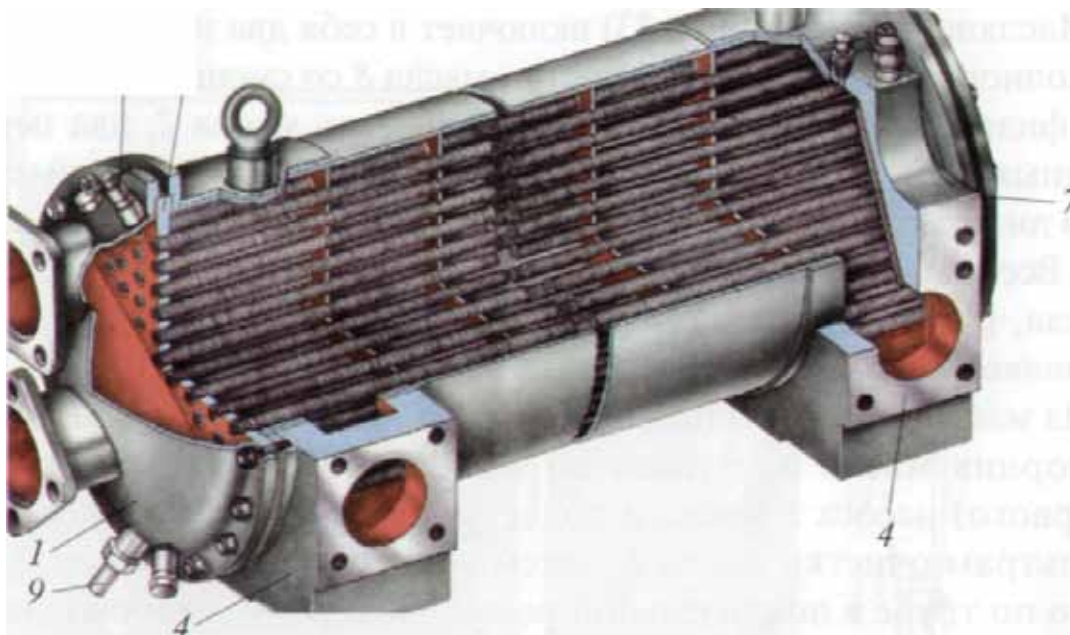
Рис.93. Водомасляный теплообменник дизеля 2А-5Д49:
