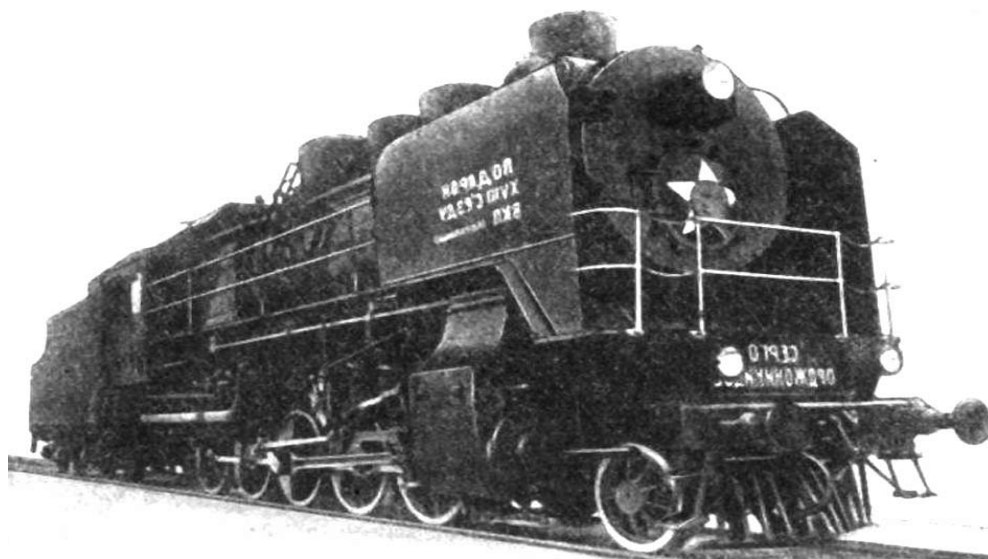
Рис. 6. Общий вид паровоза серии СО с конденсацией пара
