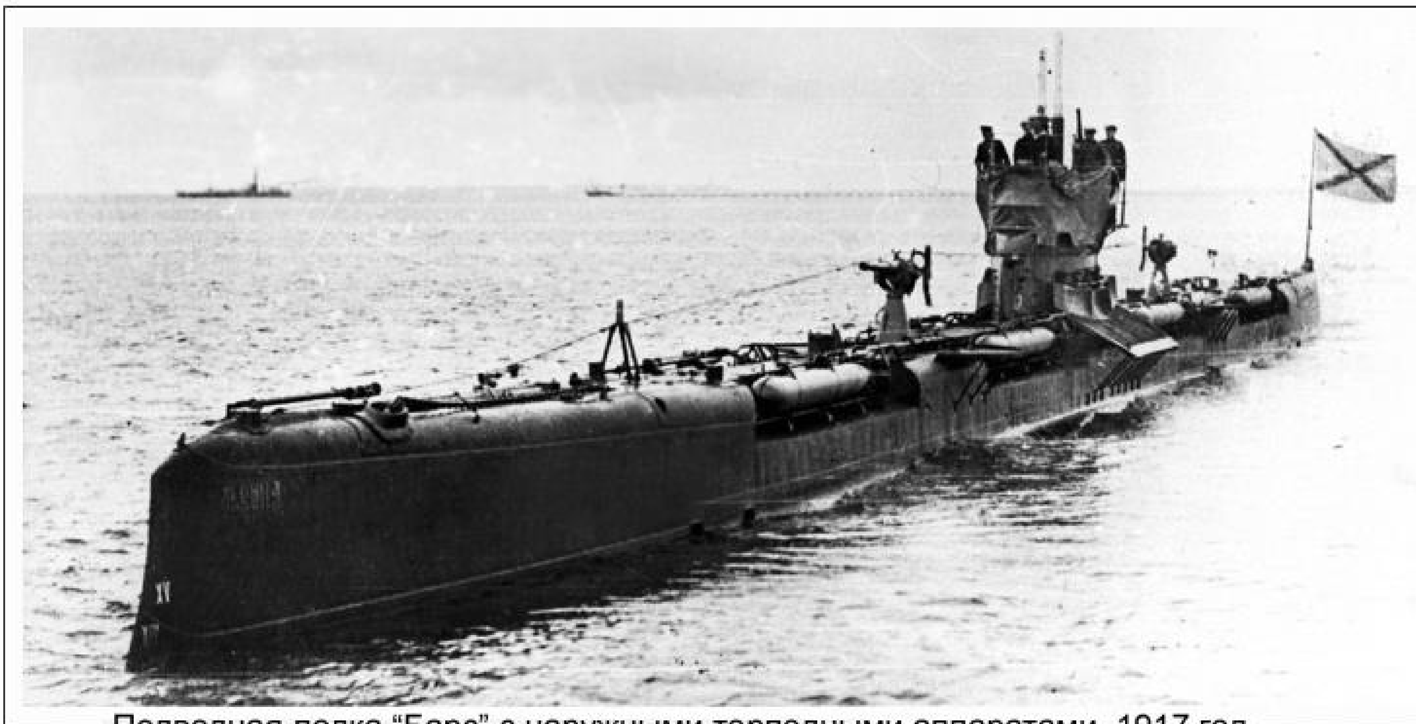
Подводная лодка «Барс» с наружными торпедными аппаратами. 1917 год.
