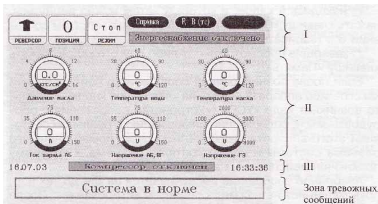
Рис. 6. Вид «основного» кадра ДМ для режимов «Дизель остановлен», «Прокатка дизеля», «Прокрутка дизеля», «Холостой ход», при стоянке тепловоза
