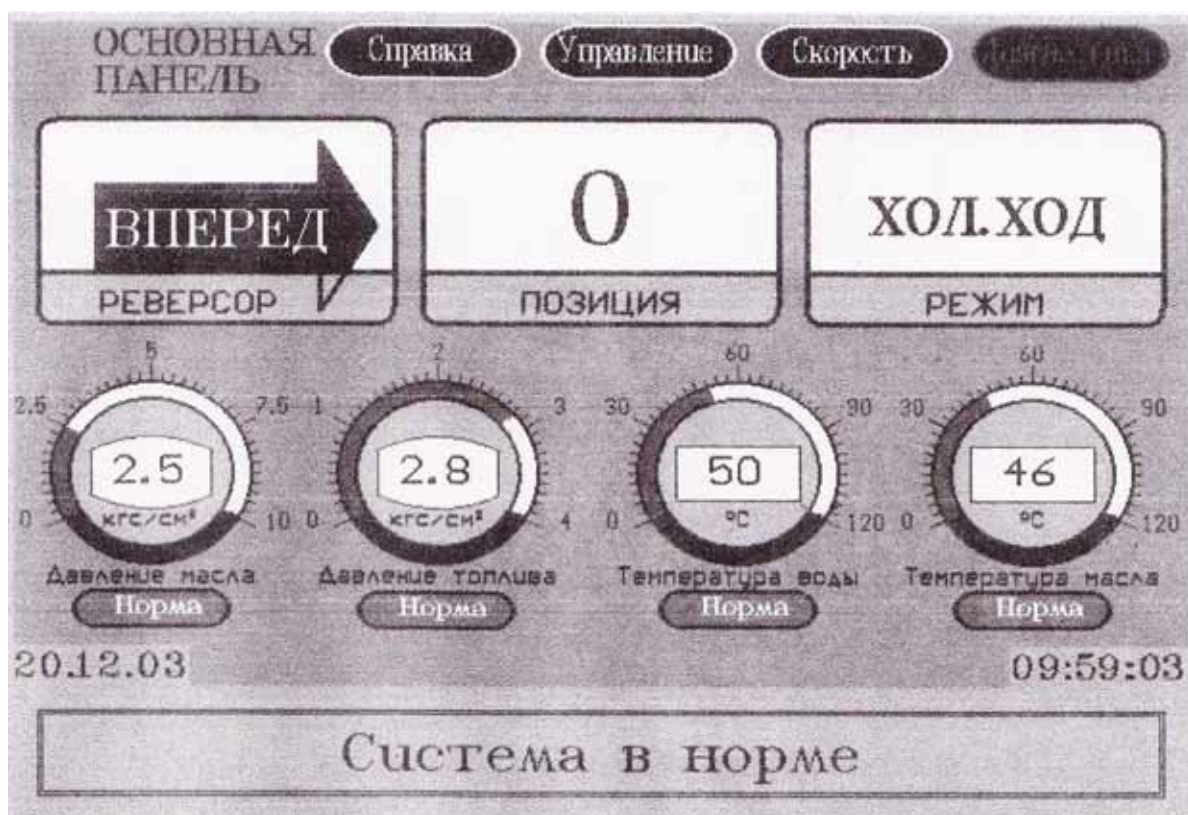
Рис. 45. Пример типового Экрана с сообщением «Система в норме».
