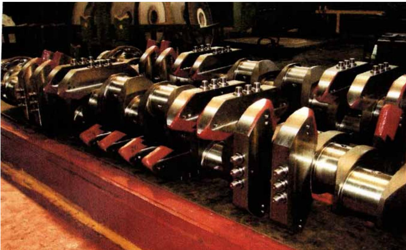
Рис.16(а). Коленчатый вал из легированной стали
