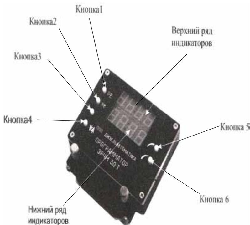
Рис.49.Общий вид программатора
