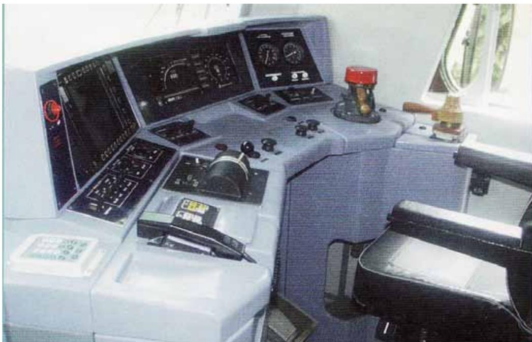
Рис.118. Пульт управления в кабине машиниста тепловоза 2ТЭ70.
