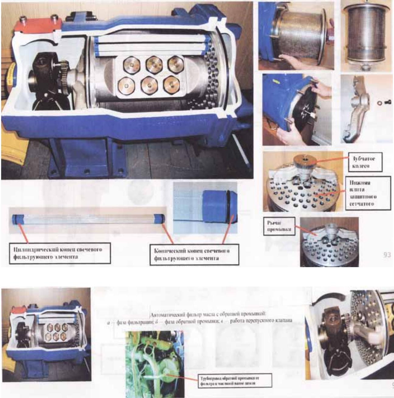
Рис.83(а).Масляный автоматический фильтр обратной промывкой фирмы «БОЛЛ-КИРХ»
